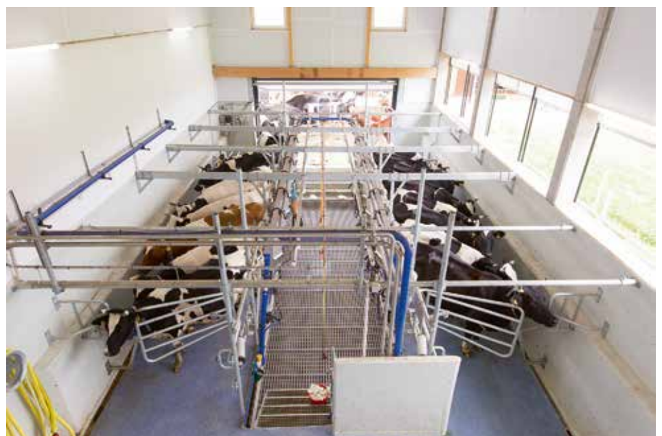
Abbildung 5: Perspektive aus dem Besuchergang: Die 80 Milchkuhe auf dem Bauckhof werden in einem 8x8 Fischgräten-Melkstand gemolken, der für Besucher:innen über einen Gang im ersten Stock des Gebäudes einsehbar ist.
