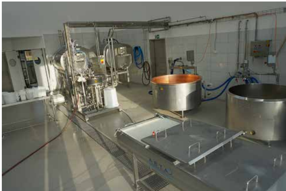
Abbildung 8: Im Produktionsraum befinden sich die Kühltanks für die Rohmilch, der Milcherhitzer, ein Kupfer- und ein Edelstahl-Käsekessel (je 800 Liter) und eine Weichkäsewanne (500 Liter).
